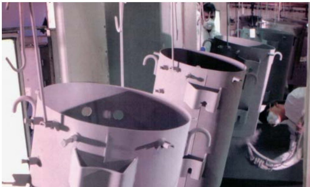
Application de poudre thermodurcissable sur cuves de transformateurs.
